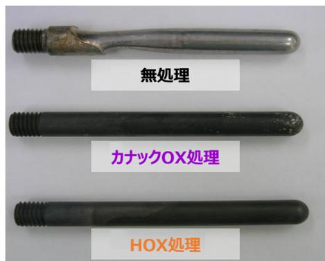
試験条件 材質 :SKD61(48HRC) アルミ:ADC12
