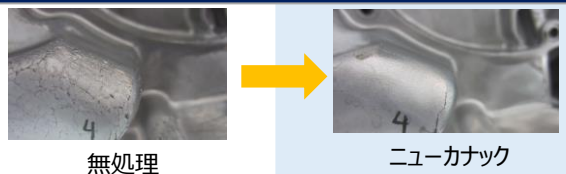
2輪エンジンカバー 約13万ショット時 表面画像の比較
